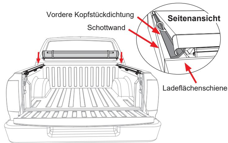
**10** Um die Abdeckung (C) mit den Seitenschienen (A und B) zu verbinden, schieben Sie die rechten und linken Kopfstückführungen in die Sperrstellung. Ein Klickgeräusch weist auf eine sichere Befestigung hin.
