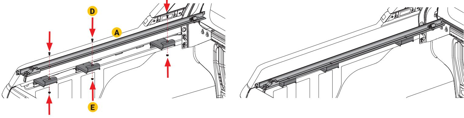
**6** **6a** – Richten Sie die Führungsschiene auf der Fahrerseite (A) am Segel aus, während Sie die M6-Schrauben anziehen. Die seitlichen Schienen sollten bündig mit der Oberkante der Stirnwand und der Oberkante der Heckklappe liegen. Die Schienen können leicht nach oben oder unten eingestellt werden, um eine optimale Abdichtung an der Heckklappe oder Stirnwand zu erreichen.
