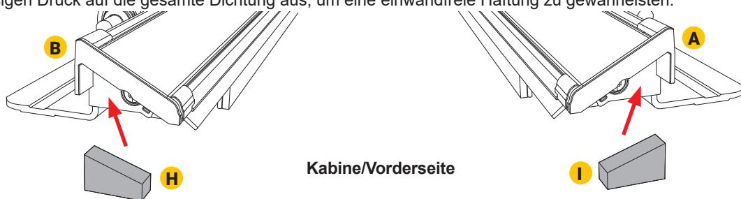
**5** Montieren Sie die Führungsschiene auf der Fahrerseite (A) mit der M6-Schraube (D) und der M6-Mutter (E), um die Schiene an den in Schritt 3b installierten Halterungen zu befestigen. Wiederholen Sie den Vorgang auf der Beifahrerseite mit der Führungsschiene (B) unter Verwendung derselben Schrauben und Muttern. **Ziehen Sie die Befestigungen vorerst noch nicht fest.**
