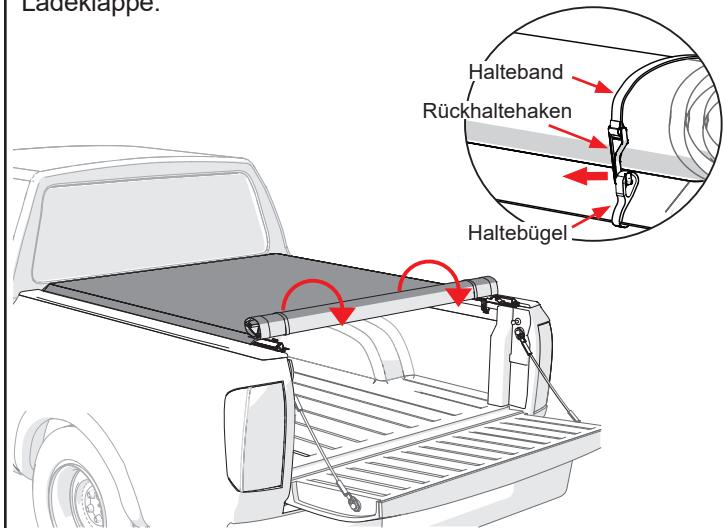
**12** Platzieren Sie das hintere Kopfstück in den Kopfstückanschlag auf beiden Seitenschienen. Drehen Sie das hintere Kopfstück nach unten, bis sie fühlen, dass die Abdeckung einrastet. Ein Klickgeräusch weist auf eine korrekt installierte Abdeckung hin.
