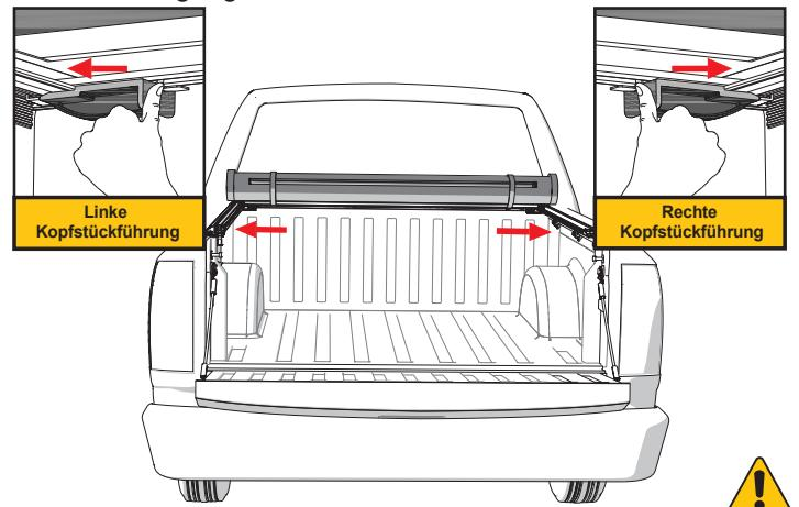
**11** Um mit der Abdeckung in geschlossener Position zu fahren, lösen Sie die Rückhaltehaken aus den Haltebügeln und entrollen Sie die Abdeckung in Richtung der Ladeklappe.
