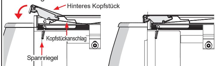
**Bevorzugtes Schließverfahren:** Ladeklappe schließen und dann Abdeckung oben an der Ladeklappe schließen. Dieses Verfahren funktioniert bei einigen Truck-Anwendungen nicht. Verwenden Sie dann stattdessen das Alternativverfahren.
