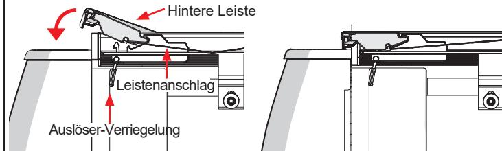
**Bevorzugte Schließmethode:** Schließen Sie die Heckklappe und dann die Abdeckung über der Heckklappe. Diese Methode funktioniert nicht bei allen Fahrzeugmodellen. Verwenden Sie stattdessen die alternative Methode.
