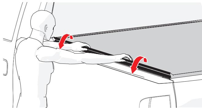
**14** Platzieren Sie das hintere Kopfstück in den Kopfstückanschlägen auf beiden Seitenschienen. Drehen Sie das hintere Kopfstück nach unten, bis sie fühlen, dass die Abdeckung einrastet. Ein Klickgeräusch weist auf eine korrekt installierte Abdeckung hin.
