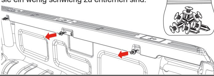
**4** Bringen Sie die sechs Klemmhalterungen (D) im Laderraum an den Stellen an, an denen Sie in Schritt 3 die werkseitigen Kunststoffclips entfernt haben. Die Kontermutter von Klemme (D) gehört hinter die Kunststoff-Ladeflächenkappe und das Fahrzeugblech. Lassen Sie die Befestigungselemente vorerst locker.
