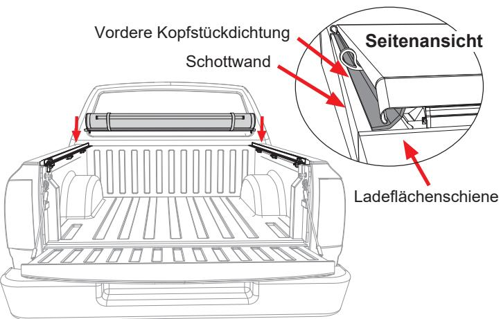
**12** Um die Abdeckung (C) mit den Seitenschienen (A und B) zu verbinden, schieben Sie die rechten und linken Kopfstückführungen in die Sperrstellung. Ein Klickgeräusch weist auf eine sichere Befestigung hin.
