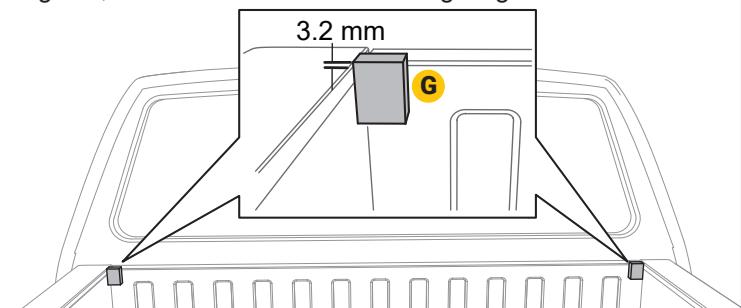
**3** Entfernen Sie drei der vier werkseitig angebrachten Kunststoffclips, wie unten abgebildet. Zuerst in der Mitte losschrauben und dann den gesamten Clip herausheben. Sie werden nicht mehr gebraucht, solange Sie die Ladeflächenabdeckung nicht dauerhaft entfernen. Achtung: Gehen Sie beim Entfernen der Kunststoffclips vorsichtig vor. Diese Clips sind eingeschraubt und gelegentlich werkseitig überdreht, sodass sie ein wenig schwierig zu entfernen sind.
