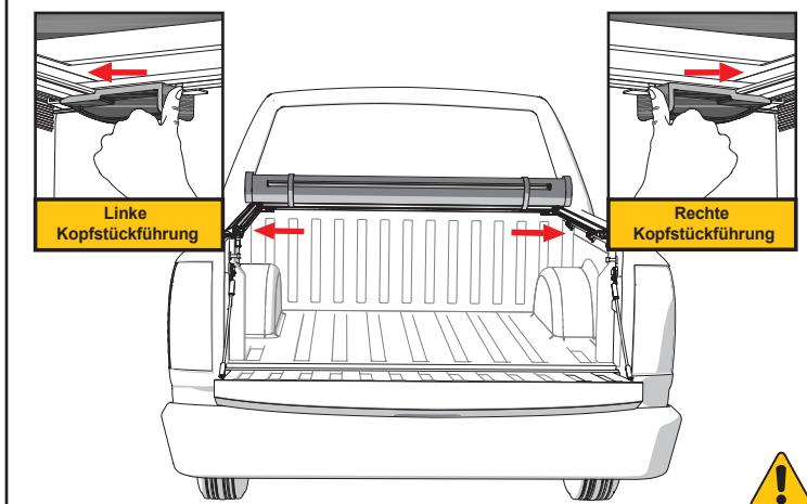
**13** Um mit der Abdeckung in geschlossener Position zu fahren, lösen Sie die Rückhaltehaken aus den Haltebügeln und entrollen Sie die Abdeckung in Richtung der Ladeklappe.
