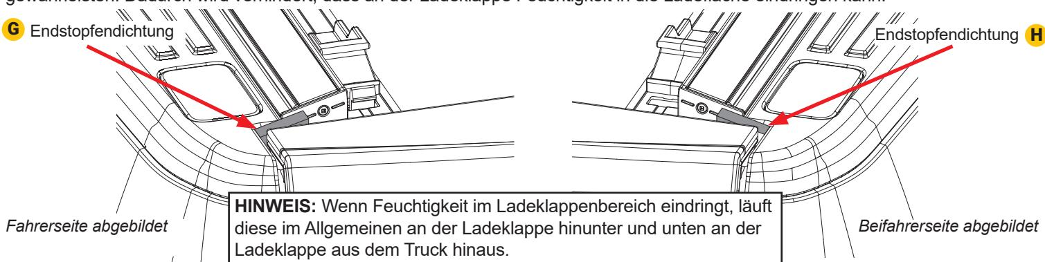
**11** Platzieren Sie die Abdeckung (C) an den Seitenschienen in Richtung Vorderseite der Ladefläche (beim Fahrerhaus). Die vordere Kopfstückdichtung soll helfen, Wasser abzuleiten und muss oben auf der Schottwand sitzen.
