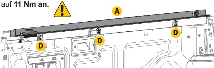
**HINWEIS:** Während des Installationsvorgangs kann es hilfreich sein, die Seitenschiene mit Federklemmen in Position zu halten.
