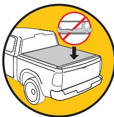
Achten Sie immer darauf, dass der Bereich frei ist, bevor Sie die Abdeckung schließen. Verriegeln Sie die Abdeckung, wenn sie nicht gebraucht wird, um ein versehentliches Schließen zu vermeiden.
