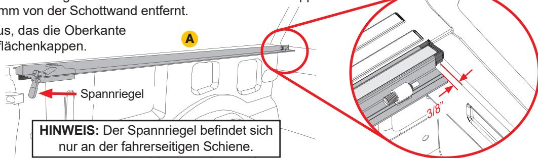
**7** Für ein optimales Verriegelungsverhalten und einen optimalen Sitz der Abdeckung müssen die Seitenschienen (A und B) auf einer Ebene mit den Ladeflächenkappen liegen und dürfen nicht nach oben oder unten geneigt sein. Zur Feinabstimmung der Seitenschienenneigung können Sie die Klemmen (D) umpositionieren. Neigen Sie die Schiene zum Anpassen nach oben oder unten. Ziehen Sie alle Klemmen (D) mit einer T-30-Schraubnuss oder einem T-Griff-Steckschlüssel auf 11 Nm an.
