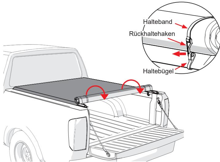
**15** Sobald die Abdeckung geschlossen ist, die Gewebelasche greifen und gleichmäßig über die Hakenbahn ziehen, sodass der Bügel in den Haken greift.
