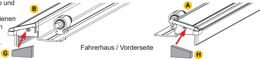
**6** Positionieren Sie die fahrerseitige Schiene (A) an der Innenseite der Ladeflächen schiene und achten Sie darauf, dass der Flansch der fahrerseitigen Schiene oben auf der Ladeflächenkappe sitzt. Die Vorderkante der Schienen ist 9,5 mm von der Schottwand entfernt.
