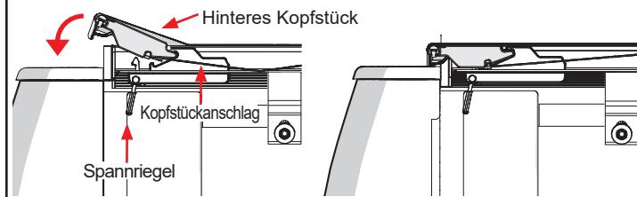
**Bevorzugtes Schließverfahren:** Ladeklappe schließen und dann Abdeckung oben an der Ladeklappe schließen. Dieses Verfahren funktioniert bei einigen Truck-Anwendungen nicht. Verwenden Sie dann stattdessen das Alternativverfahren.
