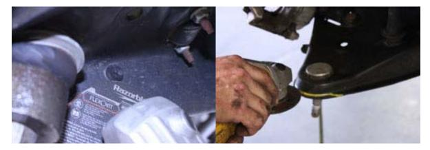
GRIND SMOOTH AND PAINT FOR RUST PROTECTION ON THE LOWER CONTROL ARM AFTER THE CUT.
