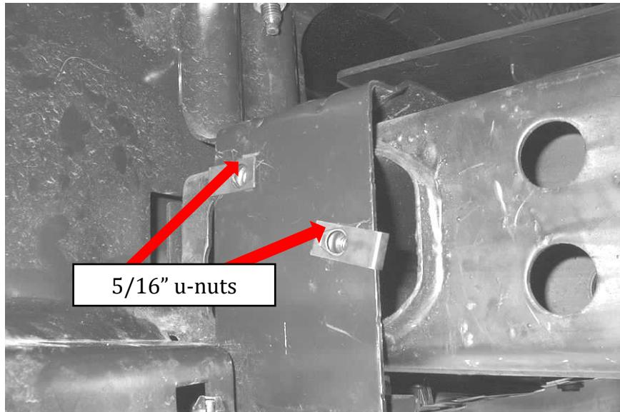
**STEP-6** INSTALL THE 5/16" U-NUTS ON THE BUMPER BRACKET AS SHOWN. NOTE: IT MAY BE NECESSARY TO LOOSEN THE BUMPER BRACKET BOLTS, AND SLIGHTLY PRY THE BUMPER BRACKET AWAY FROM THE FRAME TO INSTALL THE FRONT U-NUT.
