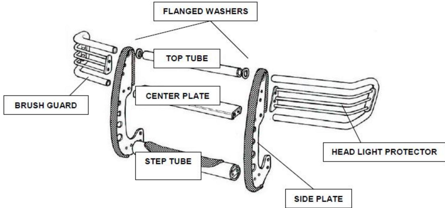
**STEP-1** BEGIN THE GRILLE AND BRUSH GUARD ASSEMBLY BY LAYING THE COMPONENTS OUT ON A PROTECTIVE SURFACE.
