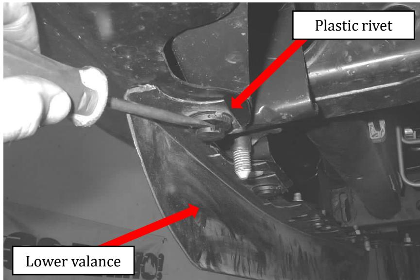
**STEP-1 REMOVE THE PLASTIC RIVETS, AND BUMPER VALANCE FROM THE BOTTOM OF THE BUMPER**
