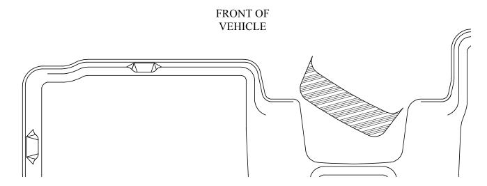
IF YOUR SUBARU IMPREZA HAS A FACTORY CONSOLE BETWEEN THE FRONT ROW SEATS, YOU WILL NEED TO TRIM YOUR LINER AS SHOWN ABOVE BEFORE INSTALLATION. TO TRIM, SIMPLY REMOVE THE AREA ON THE FRONT EDGE OF THE CENTER HUMP COVERAGE AREA USING A UTILITY KNIFE OR HEAVY SHEARS. FOLLOW THE MOLDED IN STEP IN THE LINER AS A TRIM GUIDE
