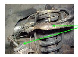
UPPER BALL JOINT REMOVED FROM THE UPPER CONTROL ARM.
