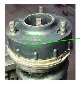
THE SIDE MARKED TOP MUST BE INSTALLED UP.
