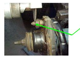
THE EXCESS STUD BEING TRIMMED OFF
