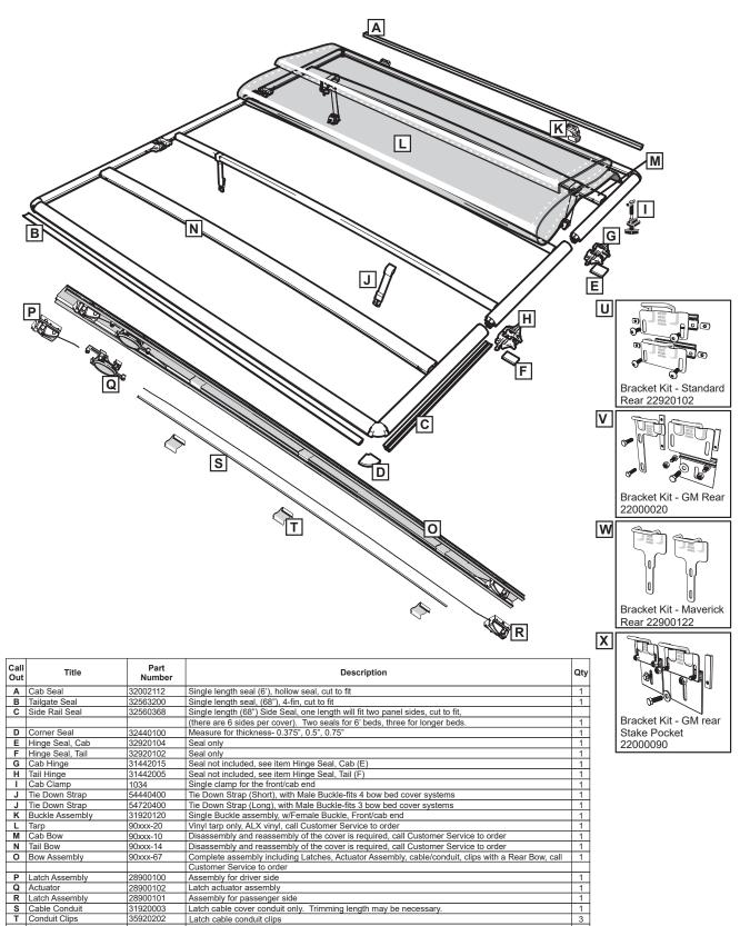
Latch cable conduit clips
