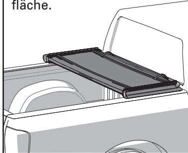
**2** Klappen Sie die Abdeckung vollständig aus und justieren Sie die Position über der Ladefläche für eine korrekte Ausrichtung von Kabine und Heck.
