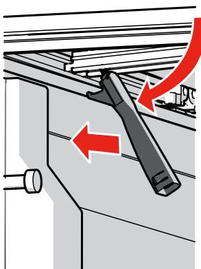
Drehen Sie die Klemme nach unten und schieben Sie sie zur Ladeflankenschiene.
