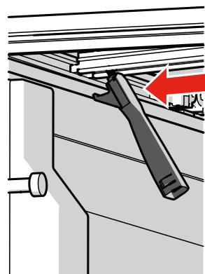
Die Klemmen sollten leicht schräg so weit wie möglich zur Schiene geschoben werden. Ziehen S
