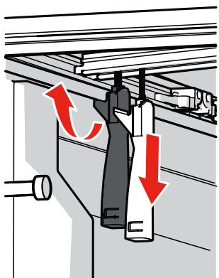
Ziehen Sie die Klemmen gerade nach unten und lassen Sie sie los, damit sie sich unter dem unteren Rand des Metallflansches der Ladeflankenschiene einhaken. Klemmen Sie immer beide Seiten des Bettes fest.
