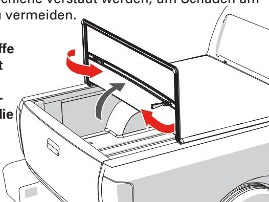
**! Klappen Sie die Abdeckung (Tonneau) nach vorne und befestigen Sie die Gurte im mittleren Bereich an der vorderen Schiene. Überprüfen Sie, ob die Gurte fest sitzen. Wenn dies nicht erfolgt, könnte der Wind die Abdeckung zurückblasen und dadurch Schäden an der Abdeckung und am Fahrzeug verursachen.**
