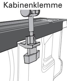
**4** Stellen Sie sicher, dass die Klemme unter dem Metallflansch positioniert ist. Von Hand festziehen, bis die Klemme den Flansch berührt, dann zwei weitere Umdrehungen anziehen. NICHT nur an der Lippe der Bettverkleidung oder der Kunststoffabdeckung befestigen. **KEINEN Schraubenschlüssel verwenden oder zu fest anziehen!**
