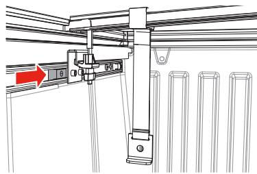
Schieben Sie den Gleitblock nach vorne zum vorderen Querträger der Abdeckung.
