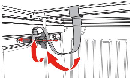
Führen Sie den Halteknauf durch die Sicherungsscheibe, durch die Haltehalterung und in den Gleitblock.
