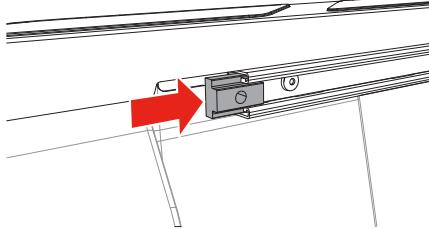
Führen Sie den mitgelieferten Gleitblock in die Ladeschiene ein.
