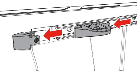
Entfernen Sie die Endkappe der Ladeschiene und alle Verzurrösen.
