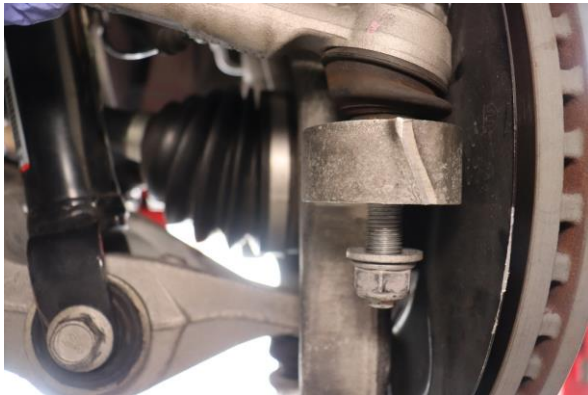
Step 6. Loosen the tie rod end nut.
