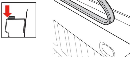
**6** Wenn beide Schienen festgeklemmt sind, legen Sie die aufgerollte Abdeckung (C) auf die Schienen an der Ladeklappe, rollen Sie die Abdeckung in Richtung Fahrerhaus und entfernen und entsorgen Sie alle Verpackungsmaterialien.
