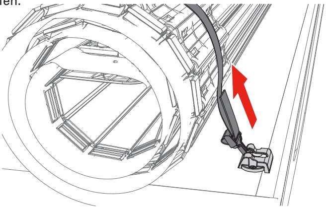
**ABDECKUNG SCHLIESSEN:** Rollen Sie die Abdeckung (C) zur Ladeklappe und drehen Sie die Heckschiene nach unten zu den Drehverriegelungshebeln.
