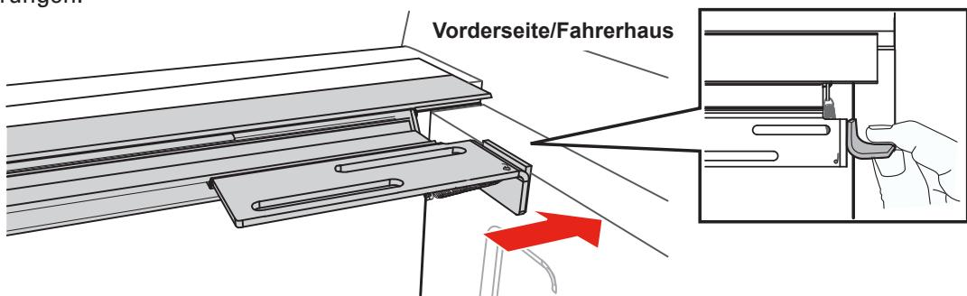
**HINWEIS:** Bei einigen einsetzbaren Laderraumwannen kann es erforderlich sein, die Ecken zu schneiden, damit die Schiene in die Öffnung passt.
