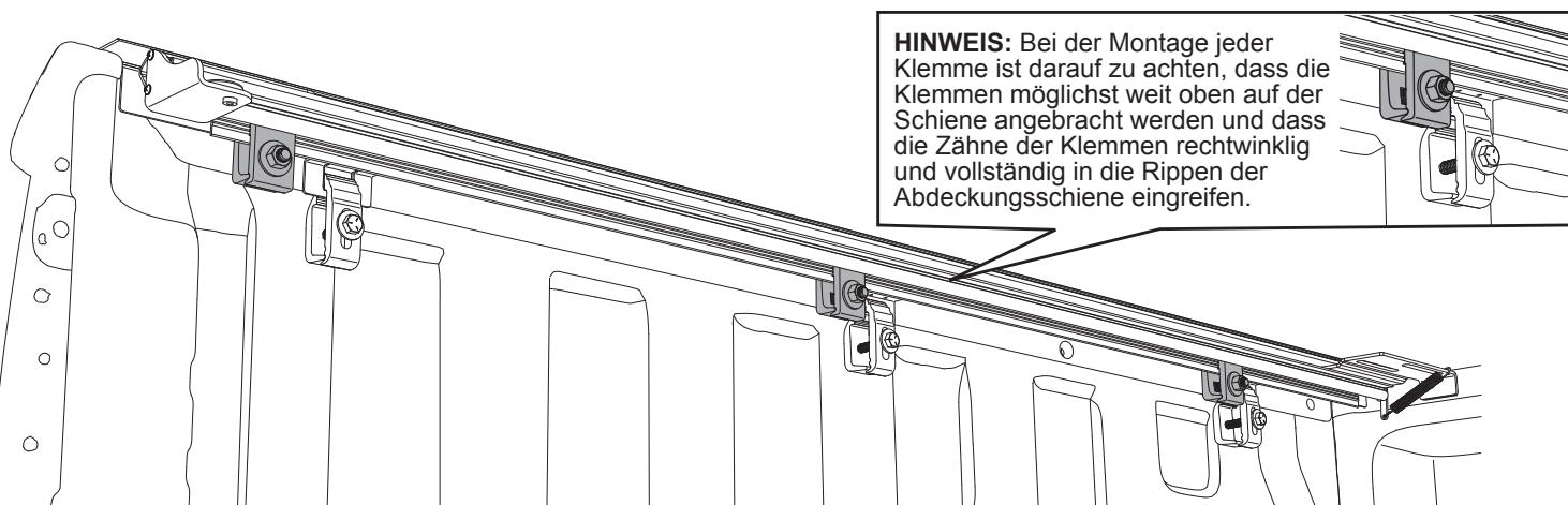
**Die Schritte 1 bis 4 für die Zusatzschiene (E) auf der Beifahrerseite und die Abdeckungsschiene (A) auf der Beifahrerseite wiederholen.**
