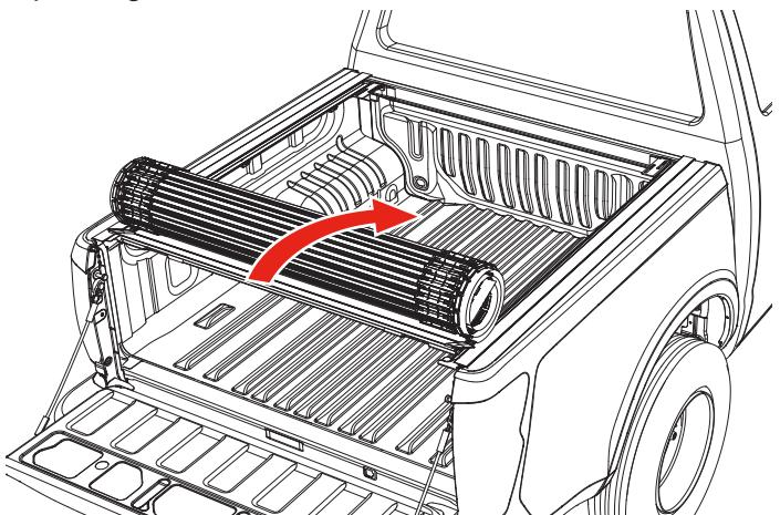
**7** Rollen Sie die Abdeckung vorwärts zum Fahrerhaus, klappen Sie die vordere Platte zurück und stecken Sie die beiden Befestigungsschrauben (K) in die geschlitzte Halterung. Führen Sie dies auf beiden Seiten durch. Die Schrauben richten sich an der geschlitzten Halterung der Abdeckungsschiene aus. Klappen Sie die Platte wieder nach unten.
