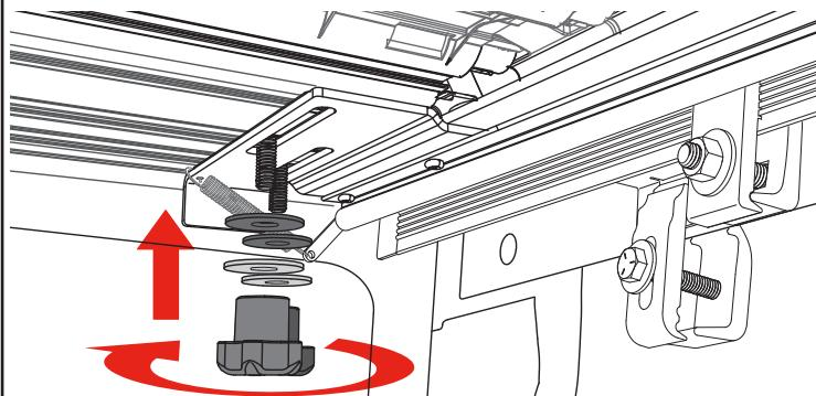
**9** Öffnen und schließen Sie die aufgerollte Abdeckung (C) mehrmals, um zu prüfen, ob sie frei rollt. Die Abdeckung sollte rechtwinklig zu den Abdeckungsschienen sein und frei zwischen den Schienen rollen.
