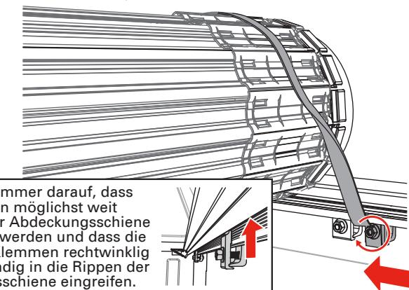
Achten Sie immer darauf, dass die Klemmen möglichst weit oben auf der Abdeckungsschiene angebracht werden und dass die Zähne der Klemmen rechtwinklig und vollständig in die Rippen der Abdeckungsschiene eingreifen.
