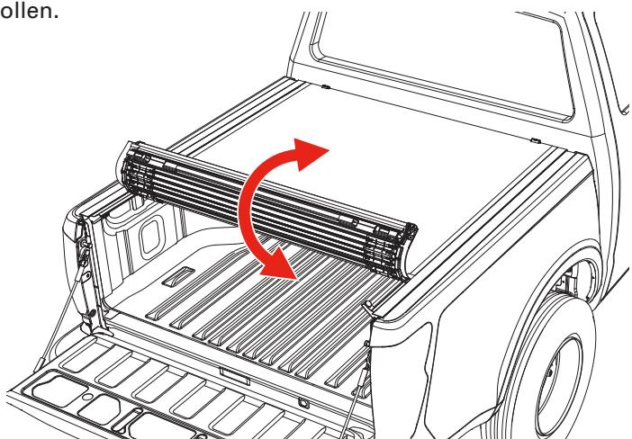
**10** Richten Sie die vordere Vinylkante der aufgerollten Abdeckung (C) an der vorderen Kante der Abdeckungsschienen aus (nicht an der Gummidichtung).
