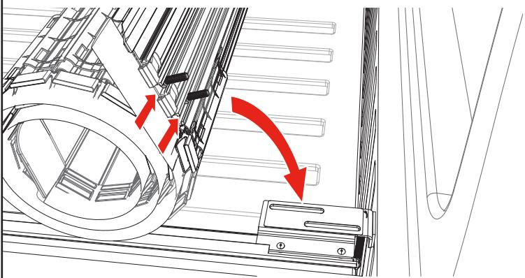
**8** Montieren Sie die Befestigungselemente lose unter der geschlitzten Halterung an der Abdeckungsschiene auf der Beifahrerseite. Beginnen Sie mit der Gummischeibe (J), dann mit der großen Unterlegscheibe (I) und ziehen Sie dann die Verriegelungsknöpfe (H) handfest an. Wiederholen Sie den Vorgang auf der Fahrerseite. Lassen Sie die Knöpfe vorerst locker.
