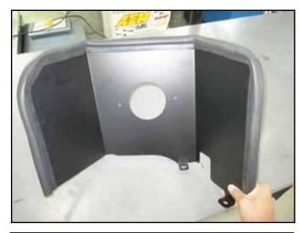
k. Install edge trim(P) onto outer edge of heat shield(Q).
