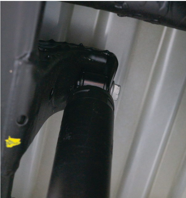
Fig. 24: Remove upper shock mount bolt.
