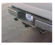
MAKE SURE YOU AT LEAST A 1" CLEARANCE ON ALL BRAKE LINES, FUEL LINES, SHOCKS, TIRES, ETC. USE ZIP TIES TO TIE THE BRAKE LINES OUT OF THE WAY.
