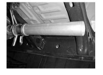
INSTALL HEADPIPE #A ONTO THE FACTORY PIPE. MAKE SURE THAT THE HEADPIPE IS STRAIGHT, NOT ANGLED UP OR DOWN. YOU MAY WANT TO LIGHTLY TAP ON THE END OF THE PIPE TO ENSURE A TIGHT FIT. CLAMP DOWN WITH THE FACTORY CLAMP AT THE FRONT OF THE HEADPIPE. DO NOT TIGHTEN.
