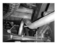
SLIP PASSENGER SIDE OVER AXLE TAILPIPE #C OVER THE OUTLET OF THE MUFFLER 1 ½ TO 2". INSERT THE WELDED HANGER INTO THE FACTORY RUBBER GROMMET, AND ATTACH TO MUFFLER
