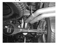
INSTALL THE DRIVERSIDE OVER AXLE TAILPIPE #D FROM THE REAR OF THE AXLE SLIP THE WELDED HANGERS INTO THE FACTORY RUBBER GROMMETS. THEN SLIP THE PIPE OVER THE OUTLET OF THE MUFFLER 1 ½ TO 2". USE CLAMP # G TO SERCURE TAILPIPES TO THE MUFFLER. DO NOT TIGHTEN.
