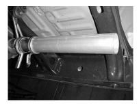
INSTALL HEADPIPE #A ONTO THE FACTORY EXTENSION PIPE. MAKE SURE THAT THE HEADPIPE IS STRAIGHT, NOT ANGLED UP OR DOWN. YOU MAY WANT TO LIGHTLY TAP ON THE END OF THE PIPE TO
