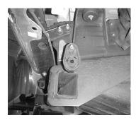
1. UN-BOLT THE FACTORY EXHAUST IN FRONT OF THE FACTORY MUFFLER. FOR EASIER INSTALLATION CUT THE FACTORY TAILPIPE BEHIND THE MUFFLER AND USE A HACKSAW TO REMOVE THE MUFFLER AND HEADPIPE. NEXT REMOVE THE FACTORY REAR HANGER UNDERNEATH THE BUMPER. LEAVE ALL OTHER FACTORY RUBBER GROMMETS IN PLACE.
