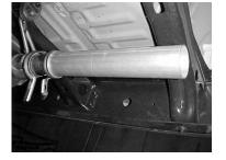
INSTALL HEADPIPE #A ONTO THE FACTORY EXTENSION PIPE. MAKE SURE THAT THE HEADPIPE IS STRAIGHT, NOT ANGLED UP OR DOWN. YOU MAY WANT TO LIGHTLY TAP ON THE END OF THE PIPE TO ENSURE A TIGHT FIT. CLAMP DOWN THE FACTORY CLAMP AT THE FRONT OF THE HEADPIPE. DO NOT TIGHTEN.
