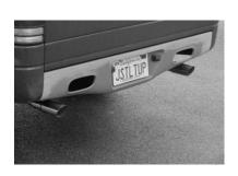
MAKE SURE YOU HAVE A 1" CLEARANCE FROM ALL BRAKE & FUEL LINES, SHOCKS, PIPES, ETC...
