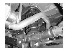
SLIP TAILPIPE # D INTO THE PASSENGER SIDE OUTLET NO MORE THEN 2" AND NO LESS THEN 1". THEN SLIP THE WELDED HANGER INTO THE FACTORY RUBBER GROMMET. USE CLAMP # H TO TIGHTEN THE CONNECTION AT THE MUFFLER OUTLET. DO NOT TIGHTEN CLAMPS.
