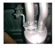
INSTALL REAR MUFFLER HANGER # E ONTO DRIVER SIDE OUTLET OF THE MUFFLER AND INSERT THE WELDED HANGER INTO RUBBER GROMMET.
