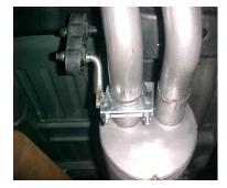
INSTALL REAR MUFFLER HANGER # H ONTO DRIVER SIDE OUTLET OF THE MUFFLER AND INSERT THE WELDED HANGER INTO RUBBER GROMMET.
