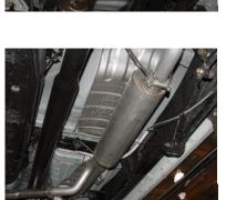
INSTALL MUFFLER #B ONTO HEADPIPE ASSEMBLY AT LEAST 1-1/2" TO 2". USE A JACK STAND TO SUPPORT THE MUFFLER. THE OUTLET OF THE MUFFLER SHOULD BE AT THE 6 O'CLOCK POSITION.
