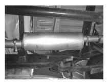
SLIP MUFFLER #B ONTO HEADPIPE #A NO MORE THEN 2" AND NO LESS THEN 1". THE MUFFLER INLET WILL HAVE THE INSIDE LOUVERS FACING FORWARD. THE OUTLET OF THE MUFFLER WILL BE POSITIONED AT 12 O'CLOCK. USE A JACK STAND TO SUPPORT THE MUFFLER.
