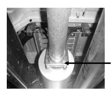
INSTALL MUFFLER # A ONTO THE STOCK HEADPIPE. SUPPORT THE MUFFLER USING A JACK STAND. INSTALL FRONT MUFFLER HANGER #F ONTO THE INLET OF THE MUFFLER. MUFFLER INLET IS LOOKING INTO LOUVERS.
