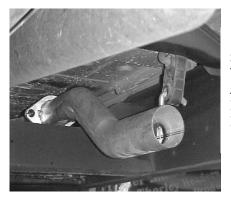
BOLT HEADPIPE #A TO THE STOCK FLANGE RE-USING THE FACTORY NUTS, BOLTS AND GASKET. INSERT WELDED HANGER INTO RUBBER GROMMET.
