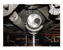
INSTALL MUFFLER #B ONTO HEADPIPE WITH INLET TOWARDS THE MOTOR. INLET OF MUFFLER IS LOOKING INTO THE LOUVERS. THE MUFFLER OUTLET SHOULD BE AT THE 4 O'CLOCK POSITION. USE CLAMP #F TO SECURE THE MUFFLER TO THE HEADPIPE. MUFFLER INLET IS LOOKING AT THE LOUVERS. DO NOT TIGHTEN.
