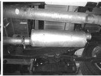
SLIDE MUFFLER ONTO THE HEADPIPE WITH THE INLET TOWARDS THE MOTOR. ADJUST FOR BETTER CLEARANCE. INLET WILL BE FACING MOTOR. PUT IT ON AT LEAST 1 ½" TO 2". MUFFLER EXIT SHOULD BE AT 12 O'CLOCK. THE MUFFLER INLET IS LOOKING INTO THE LOUVERS.
