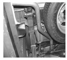
SLIP THE OVER AXLE TAILPIPE #C INTO THE OUTLET OF THE MUFFLER 1" TO 2". CONNECT REAR HANGER WITH FACTORY BOLT. HANGER #I ON THE MUFFLER OUTLET. DO NOT TIGHTEN.
