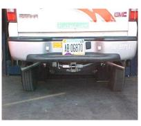
MAKE SURE YOU HAVE A MINIMUM OF A 1" CLEARANCE ON ALL PIPES FROM BRAKE & FUEL LINES. TIRES. SHOCKS. ETC...
