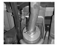
4. INSTALL MUFFLER # B. USE A JACK STAND TO SUPPORT THE MUFFLER. INSTALL FRONT MUFFLER HANGER # G AND INSERT WELDED HANGER AT THE INLET OF THE MUFFLER. THE VERTICAL ROD WILL BE POSITIONED ON THE PASSENGER SIDE OF THE HEADPIPE. DO NOT TIGHTEN MUFFLER INLET IS LOOKING INTO THE LOUVERS.
