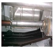
SUPER CREW TRUCKS MFG BEFORE 10-02= CUT 7" OFF ON NEW GIBSON HEADPIPE #A. DO NOT CUT ON THE SWEDGE SIDE. ATTACH THE FACTORY PIPE USING CLAMP #F.
