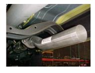
SLIDE FLANGE #B ONTO HEADPIPE #A. BOLT HEADPIPE UP TO THE FACTORY FLANGE USING YOUR FACTORY HARDWARE.
