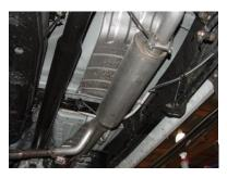
INSTALL MUFFLER #B ONTO HEADPIPE ASSEMBLY AT LEAST 1-1/2" TO 2". USE A JACK STAND TO SUPPORT THE MUFFLER. THE OUTLET OF THE MUFFLER SHOULD BE AT THE 6 O'CLOCK POSITION.
