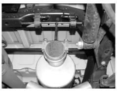
3.) NEXT INSTALL MUFFLER PART #B WITH THE INLET TOWARDS THE MOTOR. (INLET IS THE OPEN LOUVERS IN THE MUFFLER FACING THE MOTOR.) ROTATE THE MUFFLER SO THE OUTLET IS AT AN 8 O'CLOCK POSITION. USE CLAMP #G TO SECURE THE MUFFLER TO THE HEADPIPE. DO NOT TIGHTEN. MAKE SURE MUFFLER IS PUSHED ALL THE WAY ON THE HEADPIPE TILL IT HITS THE FLANGE. USE A JACKSTAND TO SUPPORT THE MUFFLER.
