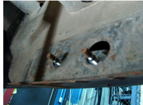
1997-98 EXTENDED CAB 3 DOOR DRIVER SIDE REAR ONLY. BOLT PLATE INSTALLATION FIGURE 6 CAMIONETA DE 3 PUERTAS, MODELO 1997-98 CON CABINA EXTENDIDA, TRASERO DEL LADO DEL CONDUCTOR SOLAMENTE. INSTALACIÓN DE LA PLACA DE PERNOS, FIGURA 6 ARRIÈRE, CÔTÉ CONDUCTEUR DU MODÈLE TROIS PORTES 97-98, CABINE RALLONGÉE SEULEMENT INSTALLATION DE LA PLAQUETTE DE BOULON FIGURE 6
