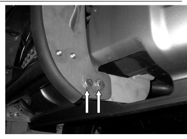
**STEP 7.** ATTACH THE GRILLE GUARD ASSEMBLY TO THE UPPER BRACKETS USING THE 3/8" FASTENERS.
