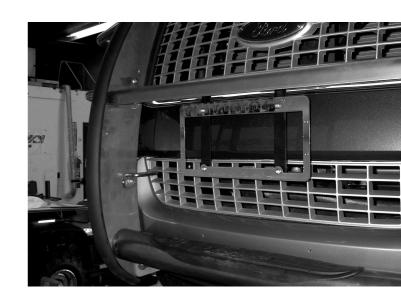
STEP 10. RE-ATTACH THE RUBBER SPLASH GUARD USING THE PLASTIC RIVETS SUPPLIED.
