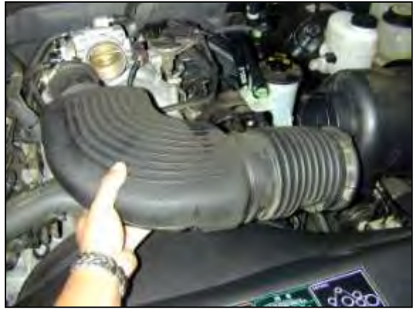
d. Remove upper inlet pipe.
