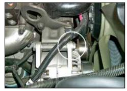
18. Remove the upper alternator bolt.
